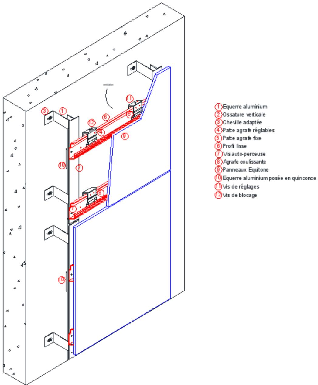
**Figure 1bis – Schéma de principe – Ossature métallique**
