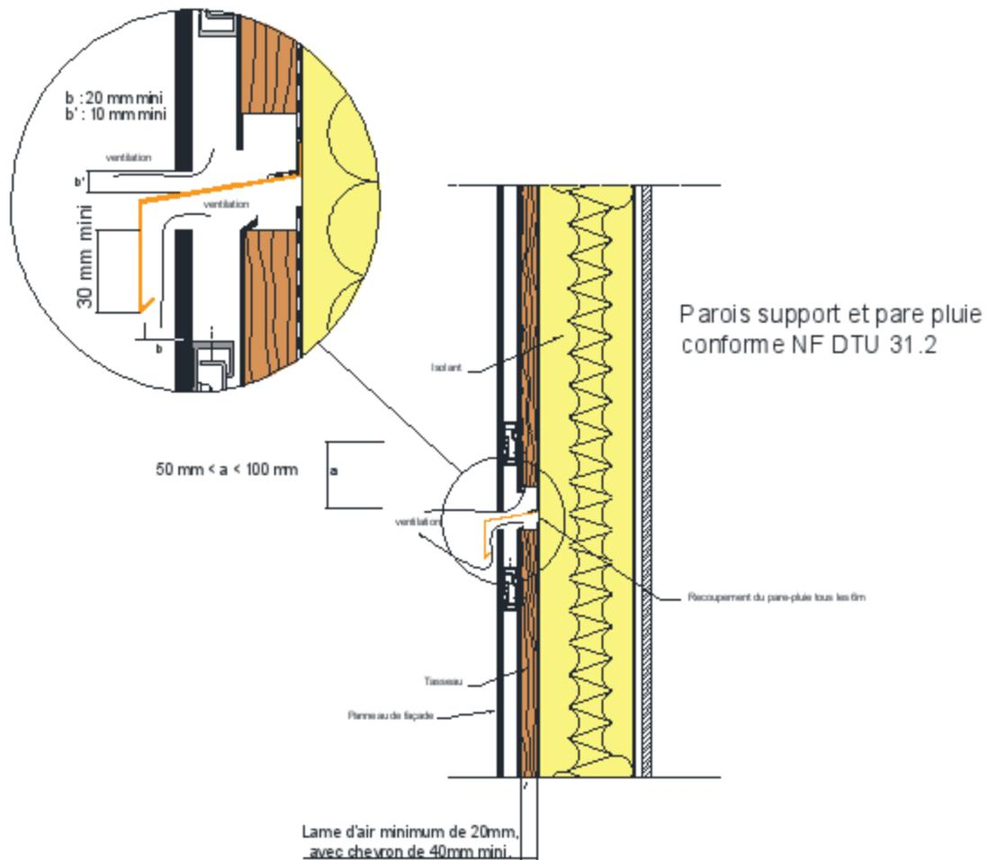
**Figure 49 – Recouvrement du pare-pluie tous les 6m**
