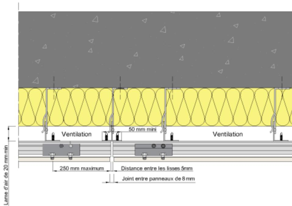
**Figure 31 – Joint vertical sur ossature métallique (coupe horizontale)**
