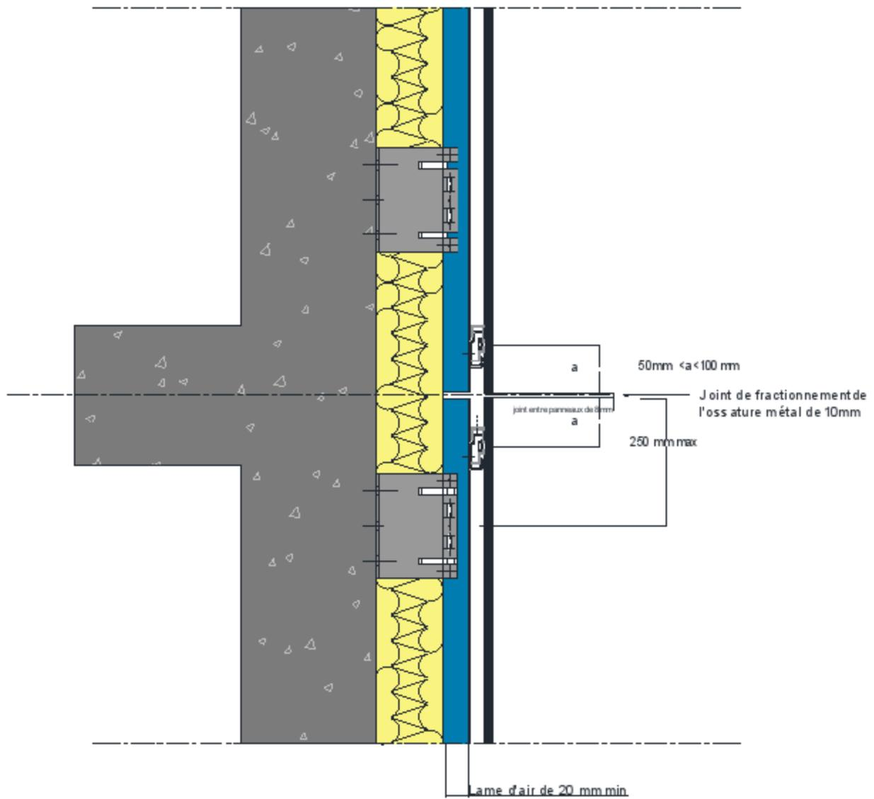
**Figure B1 – Fractionnement de l'ossature au droit de chaque plancher sur béton**
