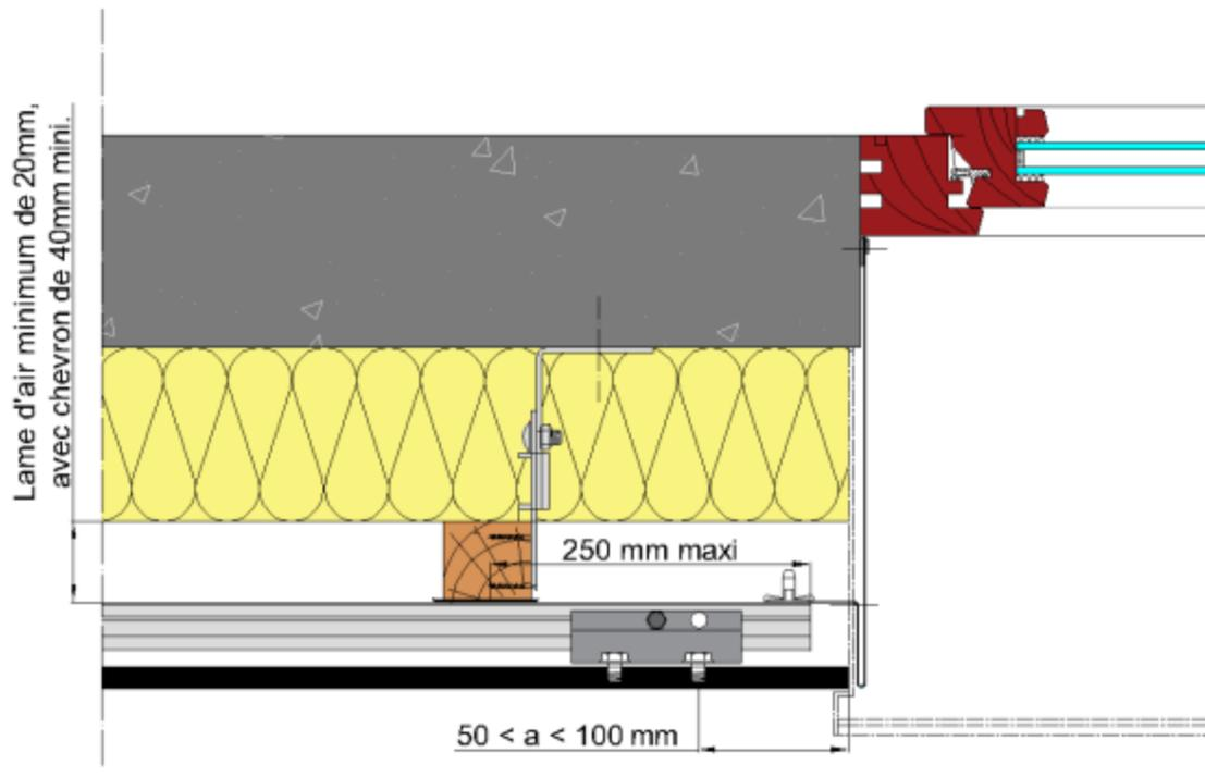
**Figure 25 – Tableau de baie : solution avec façonné métallique**
