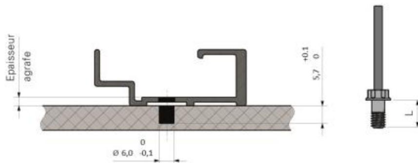
**Figure 2 – Préperçage des panneaux**
