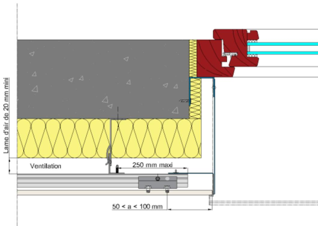
**Figure 41 - Tableau de baie : solution avec façonné métallique**
