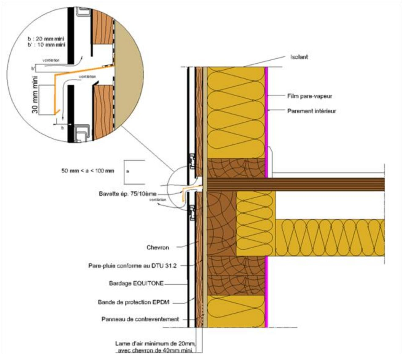
**Figure A3 – Fractionnement de l'ossature au droit de chaque plancher sur COB – avec recouvrement de pare-pluie**
