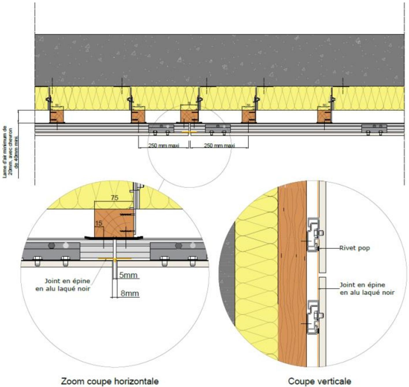
**Figure 15bis - Joint vertical avec épine en aluminium**
