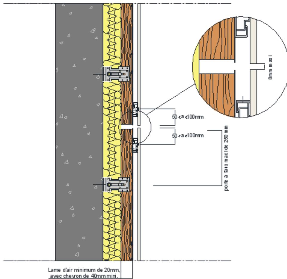
**Figure 29 - Fractionnement de l'ossature bois de longueur <math>< 5,40\text{ m}</math>**
