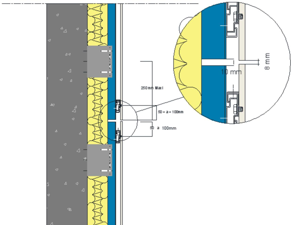
**Figure 45 - Fractionnement de l'ossature (profilé acier < 6 m ou aluminium < 3 m)**
