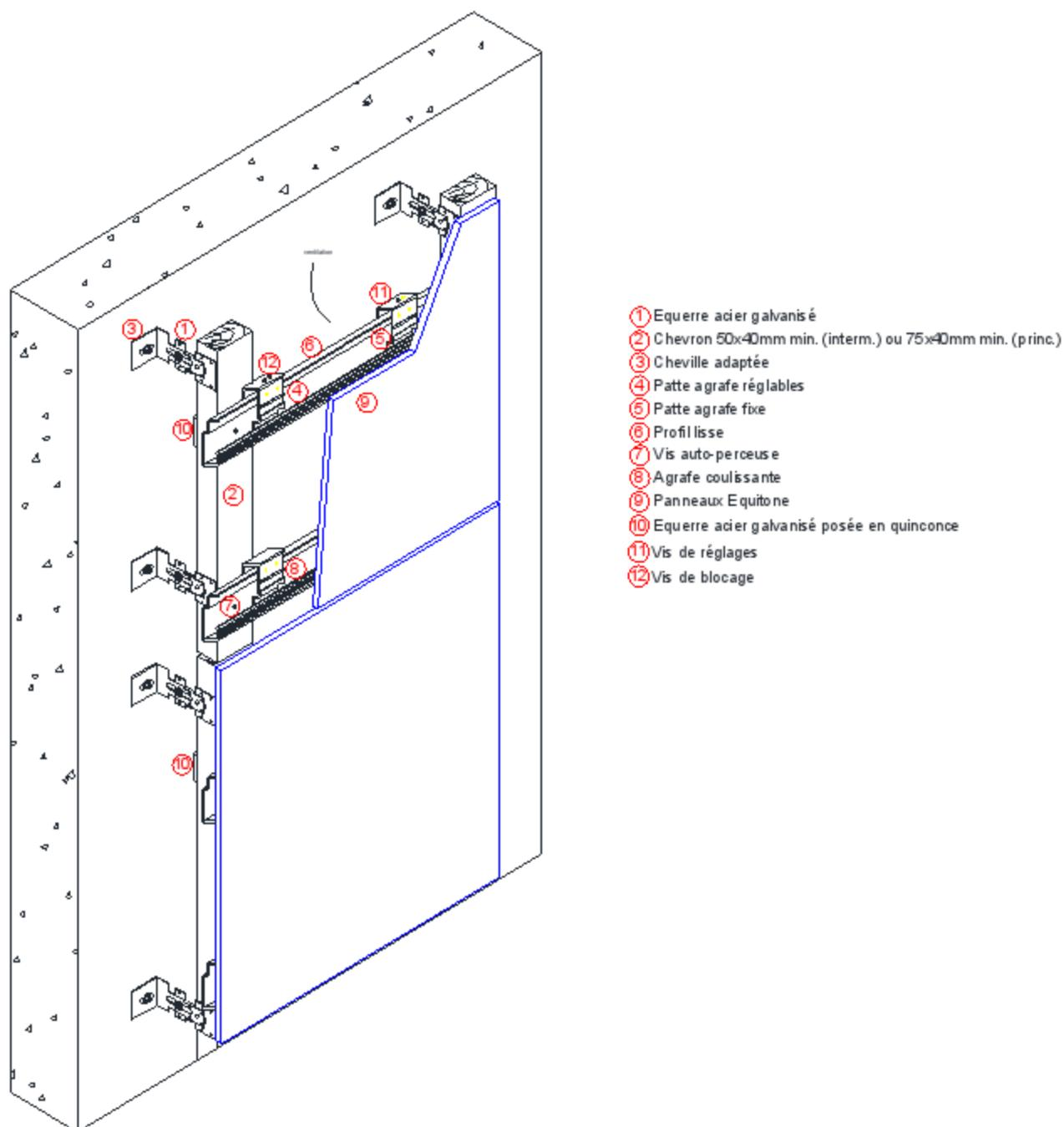
**Figure 1 – Schéma de principe – Ossature bois**
