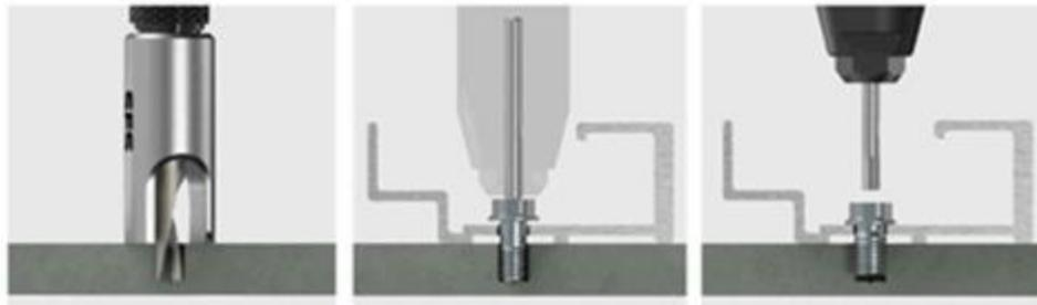
**Figure 6 – Rivet TUF et rivetage des agrafes au dos des panneaux**
