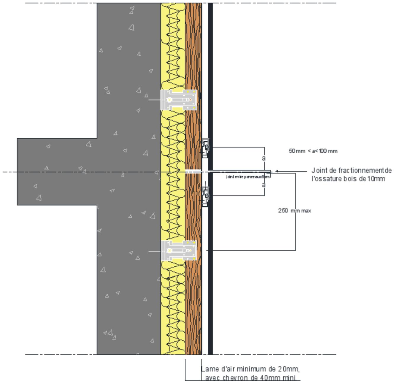
**Figure A1 – Fractionnement de l'ossature au droit de chaque plancher sur béton**
