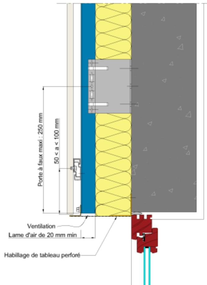
**Figure 38 - Linteau de baie : solution avec façonné métallique perforé**
