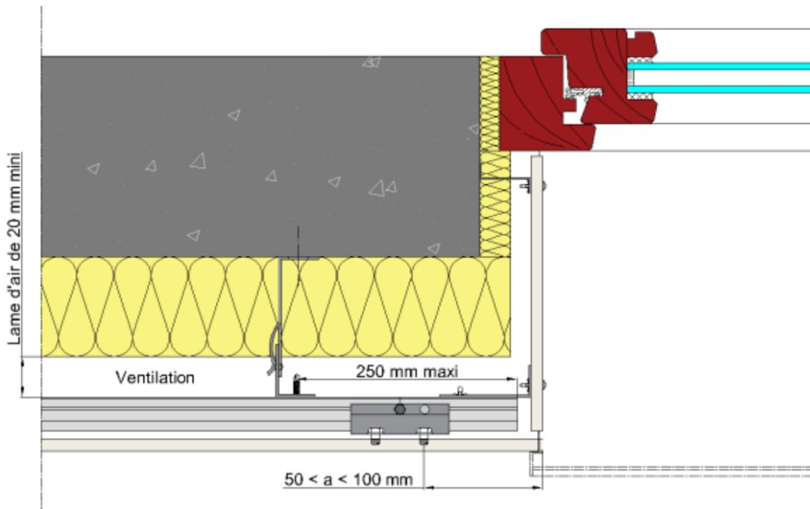
Figure 42 - Tableau de baie : solution avec panneau EQUITONE (fixation visible selon documentation en vigueur)
