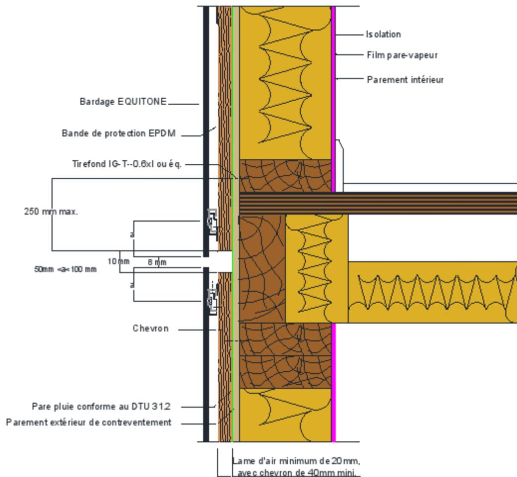
**Figure A2 – Fractionnement de l'ossature au droit de chaque plancher sur COB – sans recoupement de pare-pluie**
