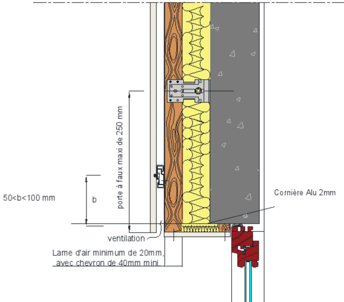
**Figure 23 – Linteau de baie : solution avec panneau EQUITONE (fixation visible)**
