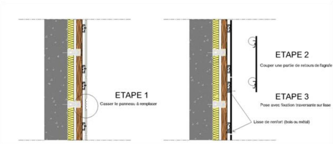
**Figure 14 – Remplacement d'un panneau**
