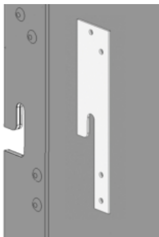
Figure 9 – Renfort d'encoche en centre de la cassette avec une tôle d'angle en aluminium EN AW-5754 t = 2 mm ou t = 3mm (cf. du Tableau 4 au Tableau 14 pour plus de précisions)
